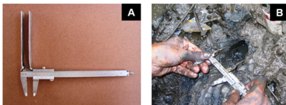
Figura 10-6. Paquímetro de precisão em aço inox adaptado com hastes metálicas (A) para o registro do diâmetro de abertura das galerias abertas de U. cordatus (B). Fotos: Anders Schmidt.
